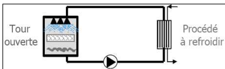
Figure 1: Circuit de refroidissement ouvert (Source MEDD/Climespace)
